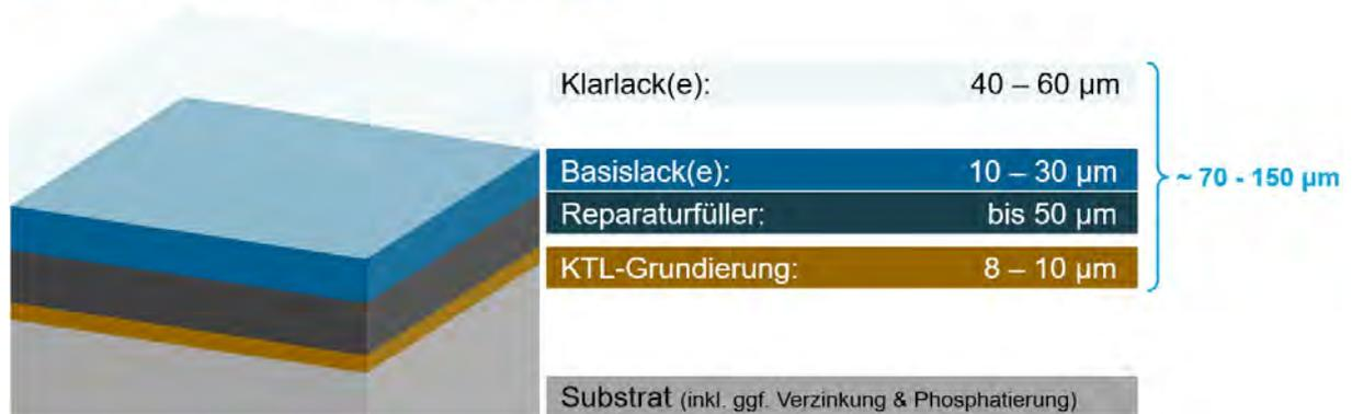
Abbildung 2: Schematischer Aufbau einer Neuteillackierung (unbeschädigtes Montageteil) inkl. Angabe von Einzelschichtdicken [AZT Automotive GmbH].
