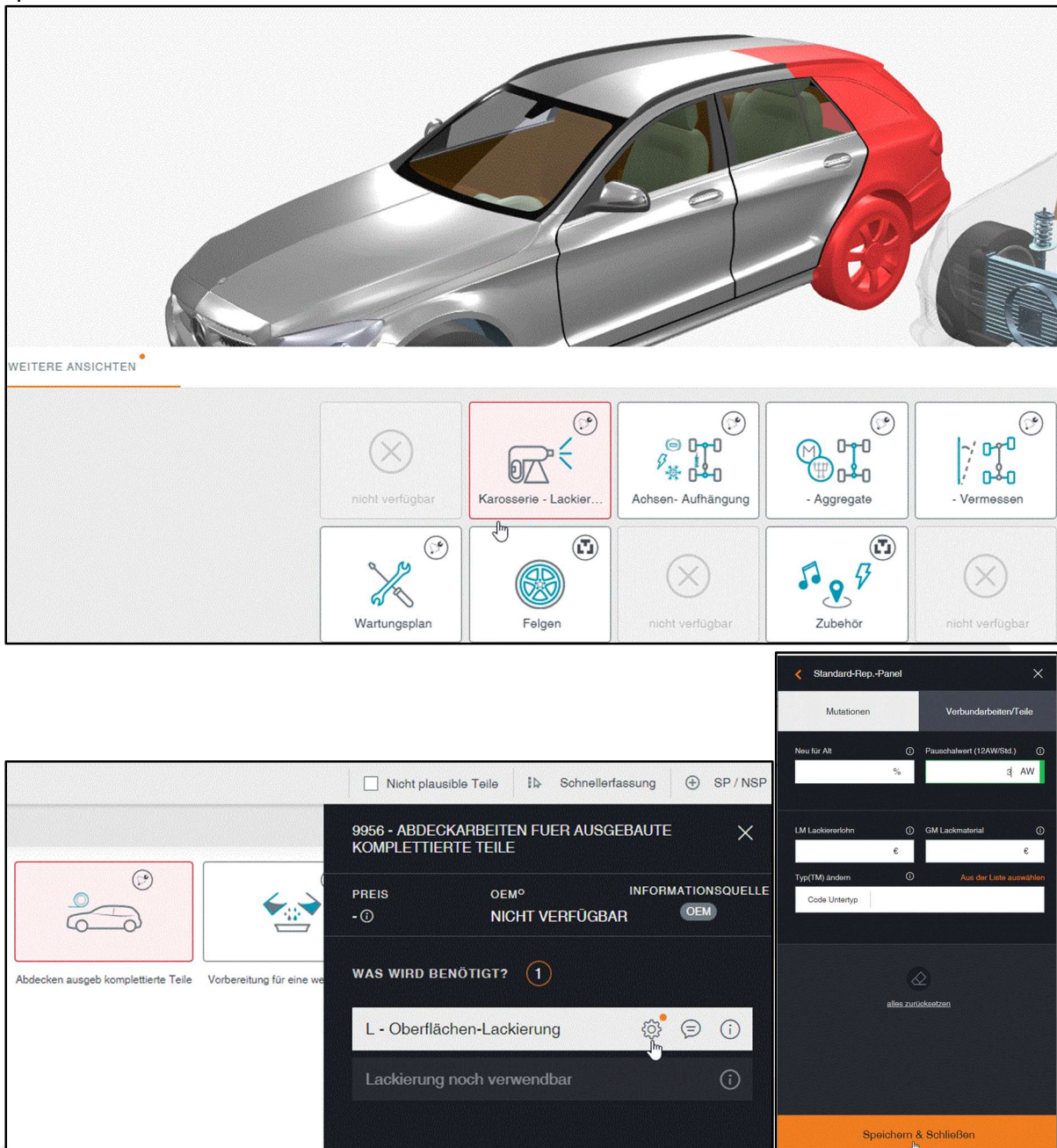
Bilder 6+7+8: Qapter Audatex, Ablauf Kalkulation Abdekarbeiten Kunststoffteil Hersteller-Lacksystem
